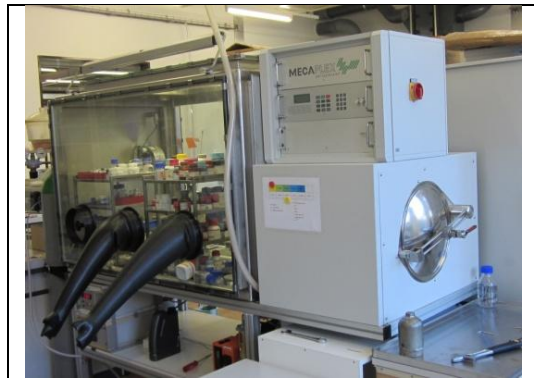
In diesem Kasten befinden sich sehr reaktive Chemikalien in Argon-Schutzatmosphäre. Rechts sieht man die Schleuse.
