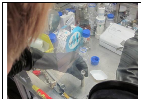
Einfüllen von dotiertem Magnesiumhydrid in den Tank (unter Schutzatmosphäre)
