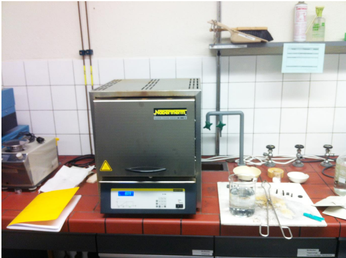
Abbildung 20: Versuchsanordnung mit Ofen, Abschreckglas, Eternitplatte und Zange.
