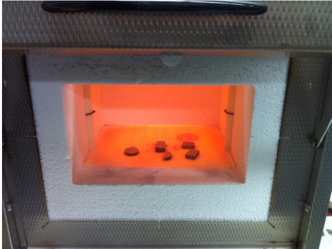
Abbildung 21: Proben im Ofen während dem Weichglühen.
