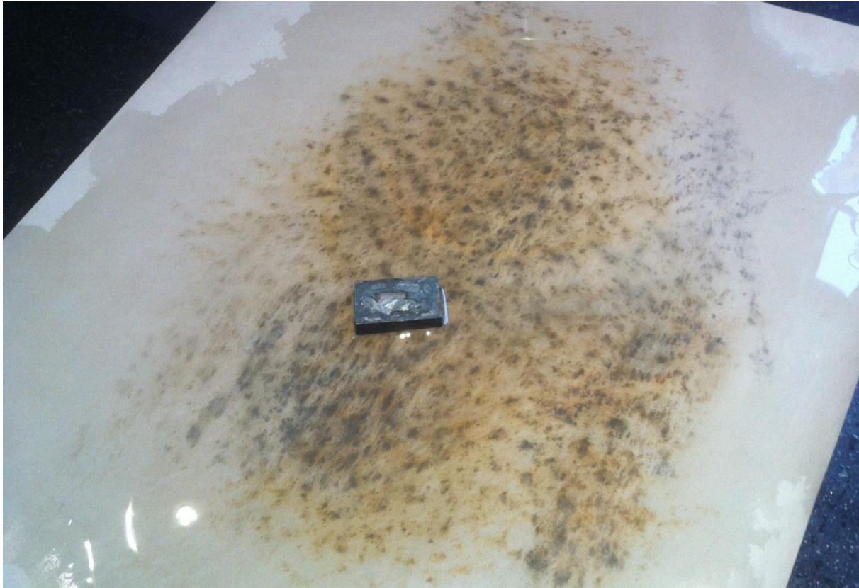
Abbildung 23: Nassschleifen und -polieren einer Probe IIII.
