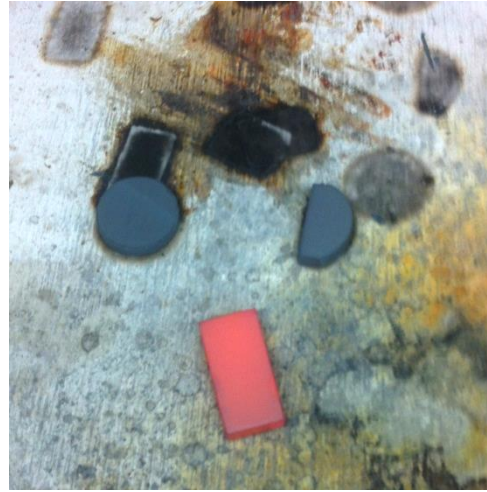
Abbildung 22: Abkühlen einer glühenden Probe an der Luft auf der Eternitplatte.
